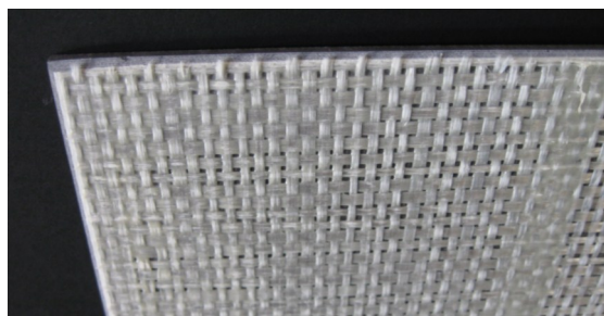
Lastre con retro rinforzato con spessore di 3,5 mm
