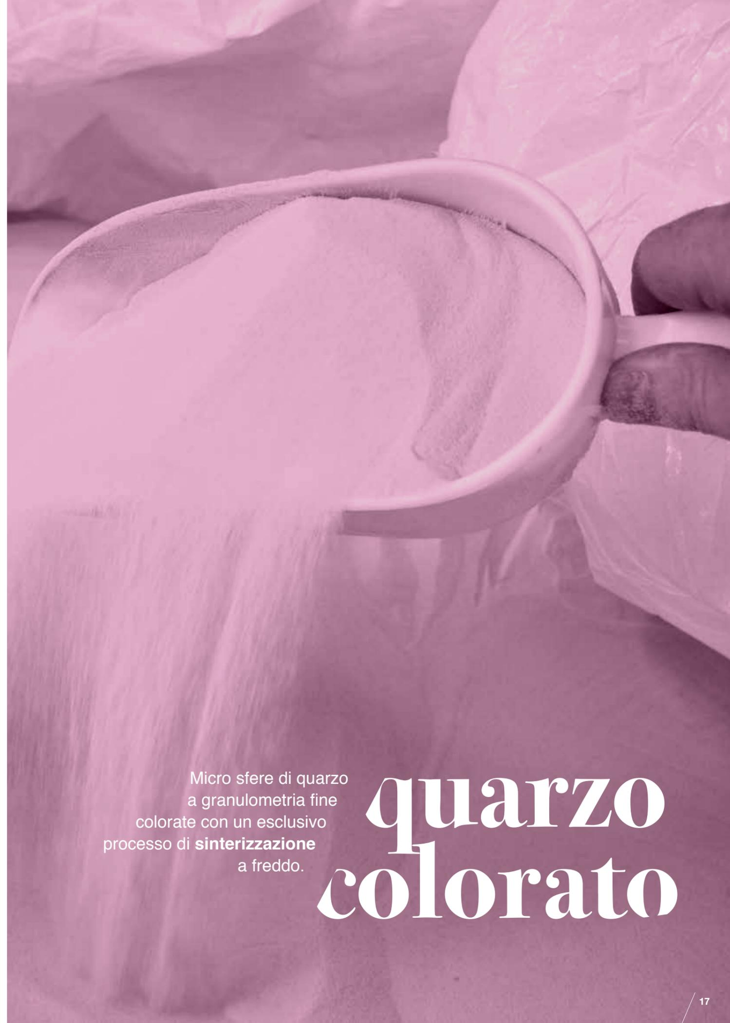
Micro sfere di quarzo a granulometria fine colorate con un esclusivo processo di **sinterizzazione a freddo**.
