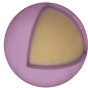
QUARZ-MIKROSPHÄREN MIT FEINER KÖRNUNG, DIE KALT GESINTERT UND MIT EINER GLEICHMÄßIGEN FARBSCHICHT ÜBERZOGEN SIND, MIT EXKLUSIVER LITOKOL-TECHNOLOGIE.
